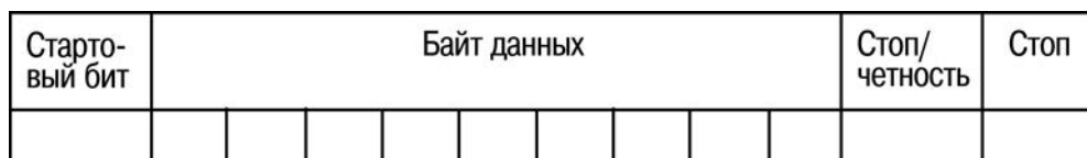
Рисунок 3.1 – Структура сообщения Modbus
